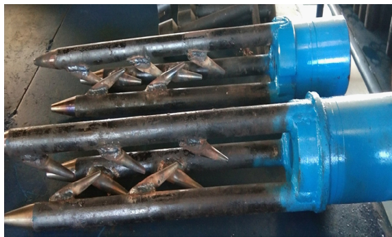
图 3 三齿内钩打捞工具
