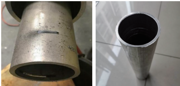
(a) 管柱切割一部分时 (b) 管柱切断
