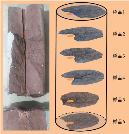
图 6 根据等间距制作大尺寸岩心铸体薄片图
