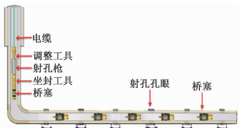
图2 泵送桥塞分段压裂工具示意图
