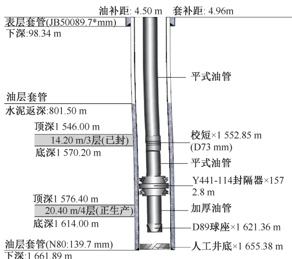
图3 Y1井管柱结构示意图 Fig.3 String structure of well Y1
