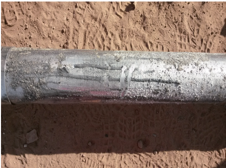
图 2 结冰的滤网 Fig.2 Frozen strainer
