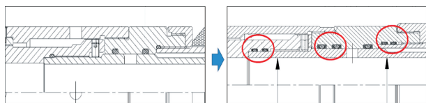
图3 长期密封部位双 O 圈示意图
