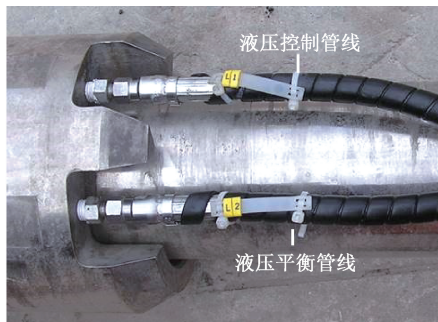
b. 注入口外接液控管线
