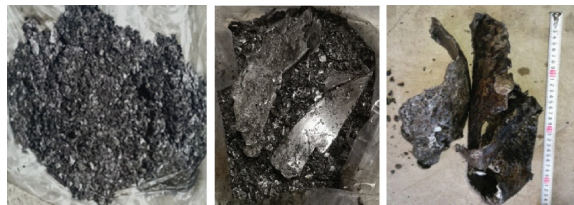
图 4 随钻捞出铁屑及铁皮
