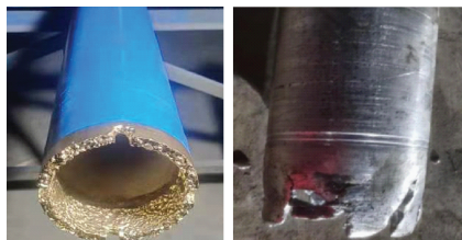
图 3 整体薄壁套铣鞋损伤情况
