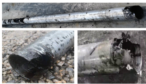
图 5 捞获射孔枪照片
