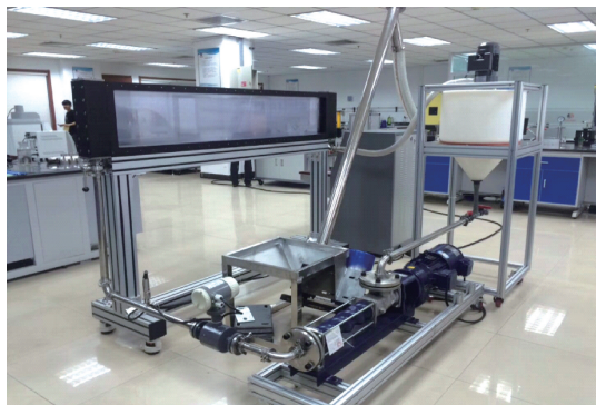
图1 裂缝模拟试验装置
