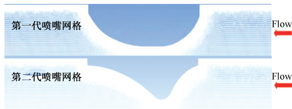
图 3 新旧两代激波雾化喷嘴的网格示意图
