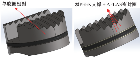
图 2 改进前后密封圈结构对比图
