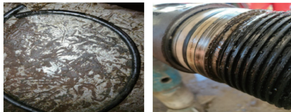
b. 克深×井出井工具密封圈没有凸起、碳化变脆
