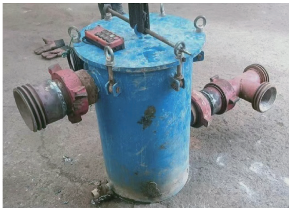
图4 入口过滤装置 Fig.4 Inlet filter unit
