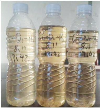
图 6 返排液破胶效果 Fig. 6 Gel breaking effect of backflow fluid
