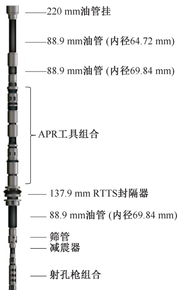
图 4 LX1 井管柱组合图
