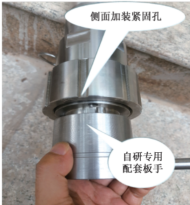
图3 防喷管连接装置改进
