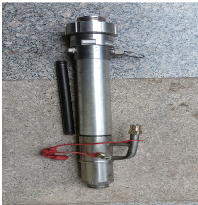
图2 改进后的井口高压防喷头
