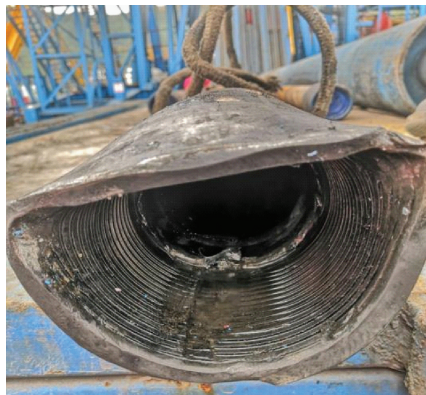
图 8 HS101 井油管接箍变形
