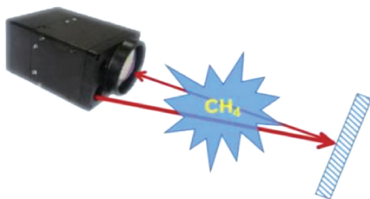
图2 瓦斯遥测原理示意
