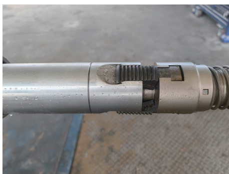
图 4 打捞出节流器密封本体实物图
